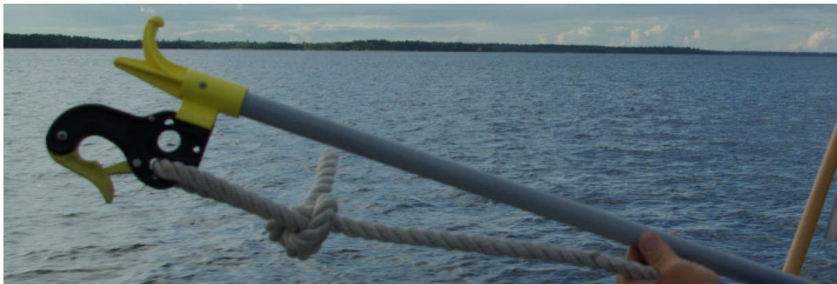
Überall, wo der Arm nicht mehr ausreicht oder eine Leine eingefädelt werden muss, kennen wir keine bessere Alternative. An der "Duck" wird mittels Palstek die Leine befestigt und dann auf einen zur "Duck" gehörenden Bootshaken gesteckt. Dann wird der Entenschnabel über den Bojenring gezogen, sodass die "Duck" einklickt und schließt. Sofort ist die Leine fest und kann eine Zuglast von 20 t halten.
