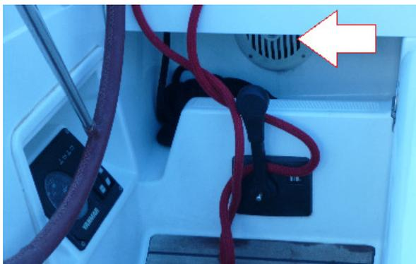
Im Achterschiff ist das Wasser durch die Außenlautsprecher eingedrungen (Foto rechts). Filippe zeigt mir das Corpus Delikti, den Stb.-Lautsprecher mit zerrissener Membran - ein Altschaden, wie er betont. Darüber hinaus hat Jeanneau hier schlecht gearbeitet und nicht dafür gesorgt, dass das Wasser abfließen kann. Die Crew hat jetzt nachträglich Lenzer eingebaut. Wir freuen uns über den offenen und nicht mehr vorwurfsvollen Ton.
