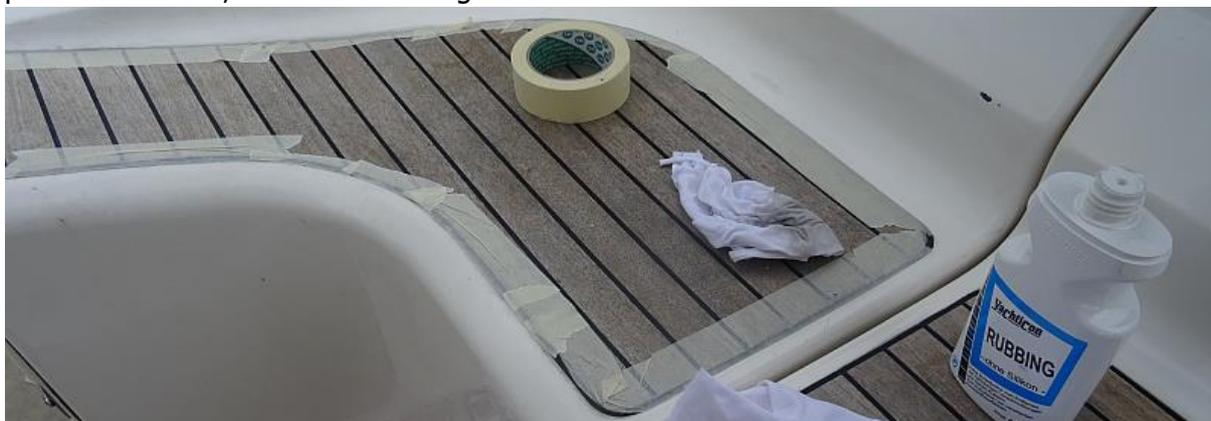
Die langwierigste Arbeit ist das Abkleben, damit die schwarze Sikkakante nicht verrieben oder verschmiert wird. Der nächste Arbeitsgang ist das Polieren mit einer Rubbingpolitur.
