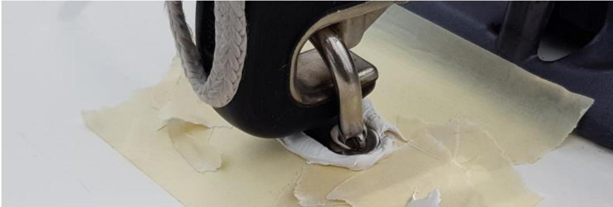
Die Klebestelle belaste ich mit dem Spibaum, damit der Kleber unter Druck aushärten kann. Das muss halten. Die ganze Aktion hat bestimmt drei Stunden gedauert – und ist leider nicht abgeschlossen.
