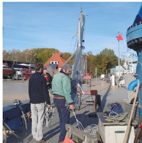
Danach wird der Mast mit dem Kran leicht angeliftet, das Achterstag gelöst, die Unter- und Oberwanten und ganz zum Schluss das Vorstag. Beinahe federleicht wird der Mast auf den Mastwagen und die Böcke abgelegt (unten).
