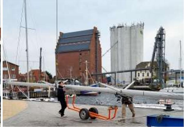
Oben links löst der Skipper den Bolzen für das Vorstag und danach wird der Mast auf dem Mastenwagen abgelegt. Jetzt sind wir wirklich ein Motorboot.
