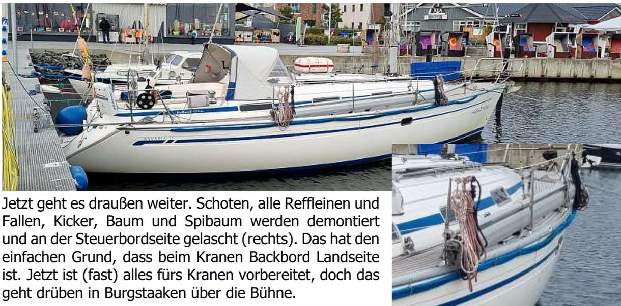
Jetzt geht es draußen weiter. Schoten, alle Reffleinen und Fallen, Kicker, Baum und Spibaum werden demontiert und an der Steuerbordseite gelascht (rechts). Das hat den einfachen Grund, dass beim Kranen Backbord Landseite ist. Jetzt ist (fast) alles fürs Kranen vorbereitet, doch das geht drüben in Burgstaaken über die Bühne.
