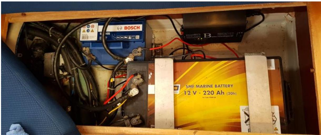
An Bord wird die neue Batterie (oben links) schnell verbaut und Skippers Welt ist wieder in Ordnung. Nun wird nur noch der Dampfer wieder in Schuss gebracht, Reinschiff!
