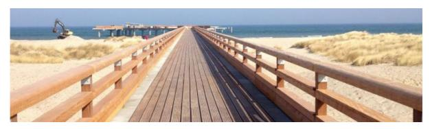
Die Brücke führt mit zweimaliger Richtungsänderung und einer Länge von 400 Metern über die See. Getragen von Stahl und Beton, wird für den maritimen Gehweg hauptsächlich witterungsbeständiges Holz wie Bongossi verbaut. Unterwegs finden sich einladende Angebote wie ein Kleinkinderspielbereich, ein Wasserspielbereich, ein Sonnendeck und ein Badedeck mit bequemen Liegen.
